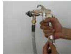
一般に吹付エア圧力は0.3~0.34MPaが標準ですが、SWS-63は吸上式のため少し高めエア圧力(0.5~0.8MPa)が必要です。ただし吹付エア圧力を必要以上に高くすると、微粒化しすぎて溶剤の蒸発も多く、また塗料の飛散も多い為、塗装効率が悪くなります。逆に吹付エア圧力が低すぎると、塗料を吸上げなかったり噴射粒子が粗くなり仕上がりに好結果が得られません。エア調節つまみあるいはコンプレッサーで圧力を調節して下さい。スプレーガンの最高使用空気圧力は1.0MPaです。
