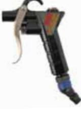
ハイパワーダスター。メッキ処理後に更に2層のベーク塗装を施すことにより内部空気通過時のガン本体の低温化を防ぎます。引金の操作で流量調節が可能です。
