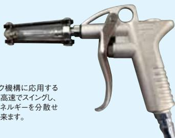
噴射の反作用をトルク機構に応用することでノズルが左右に高速でスイングし、単一ノズルで噴射エネルギーを分散せず吹き付けることが出来ます。
