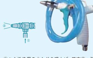
①から洗浄用の水などを吸上げ、前方②へ強く吹付けます。空気圧力は0.4Mpa以上がより効果的です。(WB)
